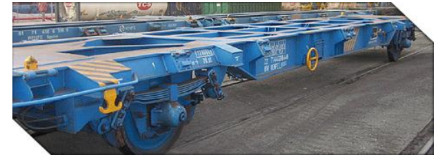
RENFE MC4E (Ancho Ibérico) 2-ejes container wagon, transporte de 2 TEU, longitud 15,08 m
