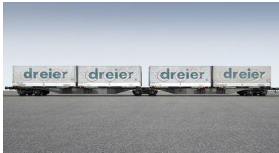
SGGMRSS 104 (ancho europeo) 6-ejes container wagon, vagón moderno y eficiente para el transporte de 4 cajas móviles (TEU), longitud 33,48 m
